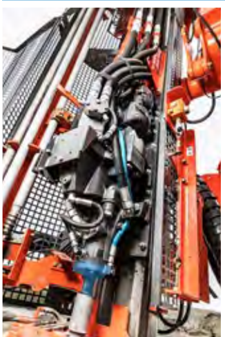
Kuva 1. Porakoneen iskuaallon muotoa mittaava heijastusaaltosensori on sijoitettu porakoneen etupäähän (kuvassa sinisellä).
