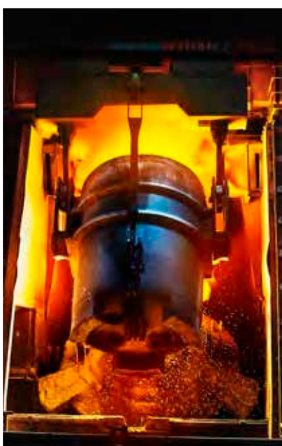
Tornion terässulaton AOD-konvertteri ja valmiita teräsruullia kylmävalssaamolta
