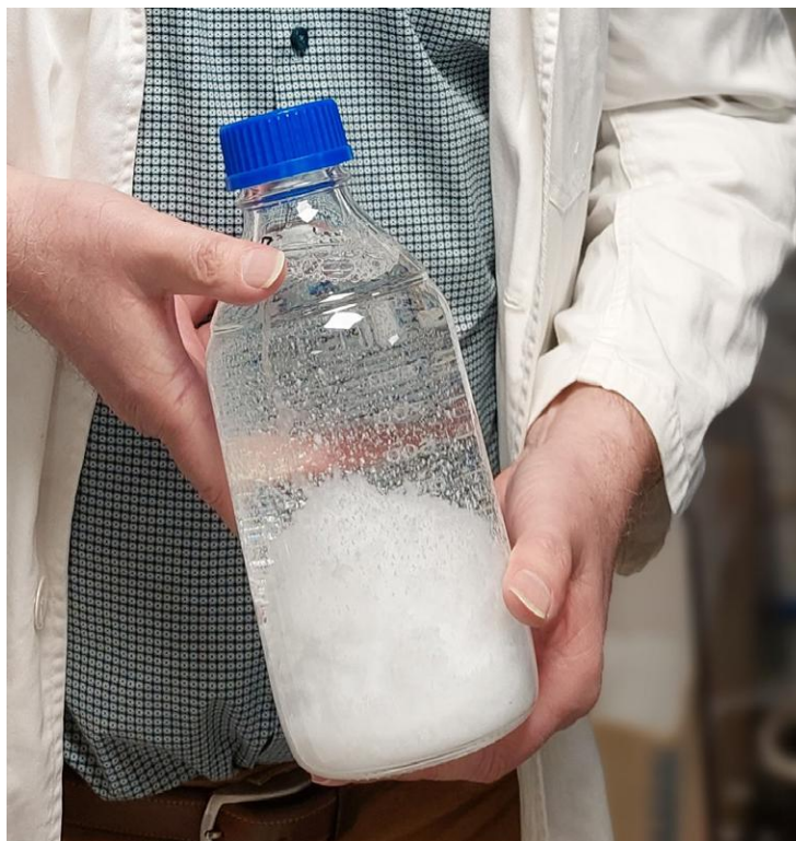
ÅA-prosessissa syntyvää magnesiumkarbonaattihydraattia ( \text{MgCO}_3 \cdot 3\text{H}_2\text{O} ) eli nesquhoniittia
