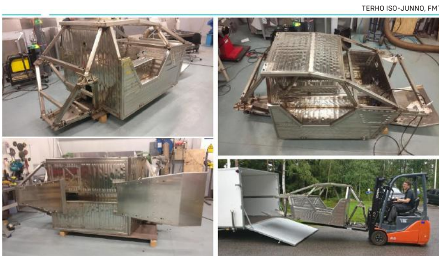
Kuva 6. ULTRA-projektissa rakennetun ralliauton rungon prototyyppi n:o 2.
