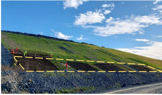
Kuva 4. Sodankylään Boliden Kevitsa Mining Oy:n sivukiven läjitysalueelle perustettiin koe, jossa testataan erilaisia kasvualustaseoksia ja kasvillisuutta. Koe edustaa arvoketjun päätepistettä.
