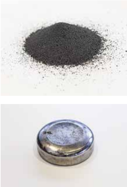
Kuva 2. Vetypelkistettyä DRI:tä ja siitä sulatettua fossiilivapaata raakarautaa
