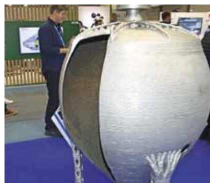
Kuva 2. 3D-tulostettu ja koeponnistettu paineastia (ks. Materia 5/2023 sivu 77) auki leikattuna. Huomaa ohut ja juoheasti muuttuva seinämänpaksuus
