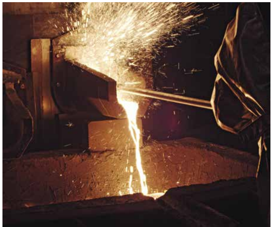
Kuva 4. Sulan laskua maaliskuussa 2023 toteutetun pilot-koeajon aikana
