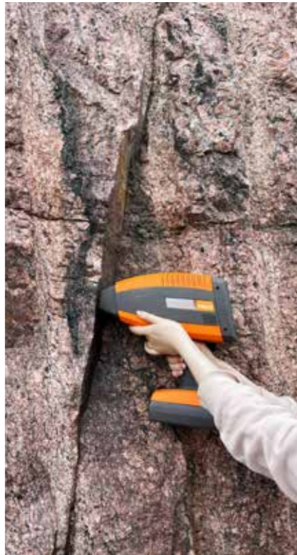
Käsikäyttöisellä hyperspektrimittarilla saa näppärästi kerätyksi tutkimusdataa maastossa.
