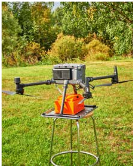
Kuva 2. Drooni-maatutka-yhdistelmä UOMARI-hankkeen testausmittauksia varten
