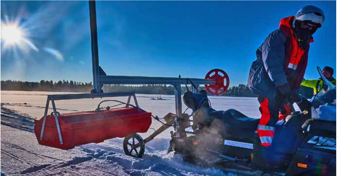
Kuva 1. Maatutkaluotauksen toimivuuden ja ilmapälin vaikutusten testausta talviolosuhteissa vedenalaisten rakenteiden mittaamisessa
