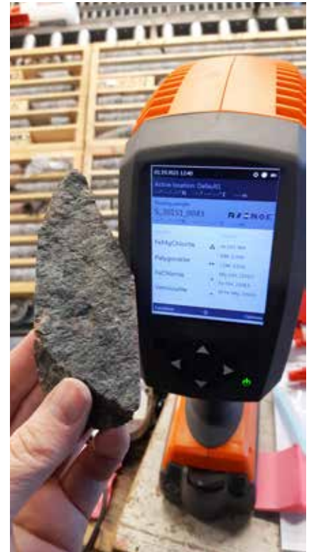
Käsikäyttöisellä hyperspektrimittarilla saa alustavaa tietoa kiven koostumuksesta.
