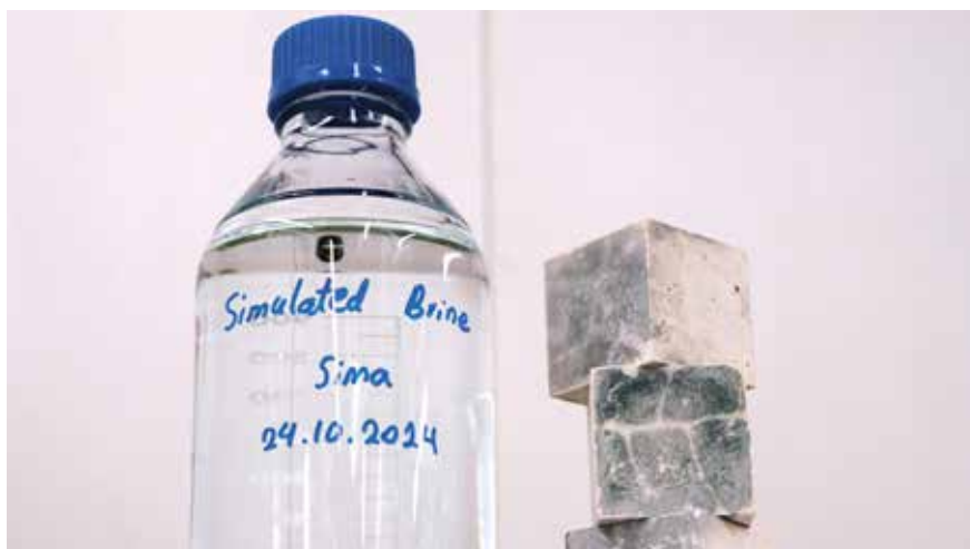
Suolavettä ja siitä masuunikuonan kanssa valmistettuja sideainepalikoita
