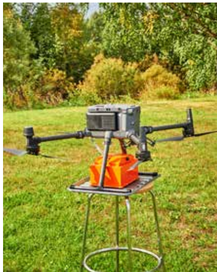
Kuva 2. Drooni-maatutka-yhdistelmä UOMARI-hankkeen testausmittauksia varten
