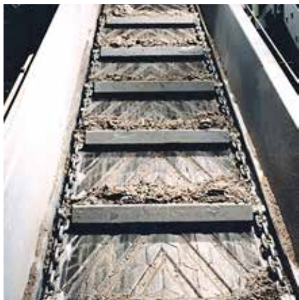
Kolakuljettimen vuoraus basalttitiilillä
