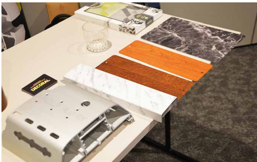
Kuva 3. Pursotettu alumiiniprofiili ja Decoral-pinnoitettuja alumiininäytteitä. Mäkelä Alu Oy
