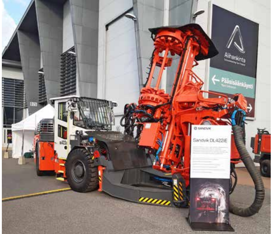
Pääsisäänkäynnin läheisyydessä oli tilaa suurten koneiden esittelyyn. Kuvassa on Sandvikin täysautomaattinen akkukäyttöinen pitkäreikätuotantoporalaite DL422iE, joka on suunniteltu maanalaiseen kaivostointintaan poikkileikkaukseltaan 4 x 4 metrin ja sitä suuremmissa tuotantoperissä. Kuva: Tuomo Tiainen
