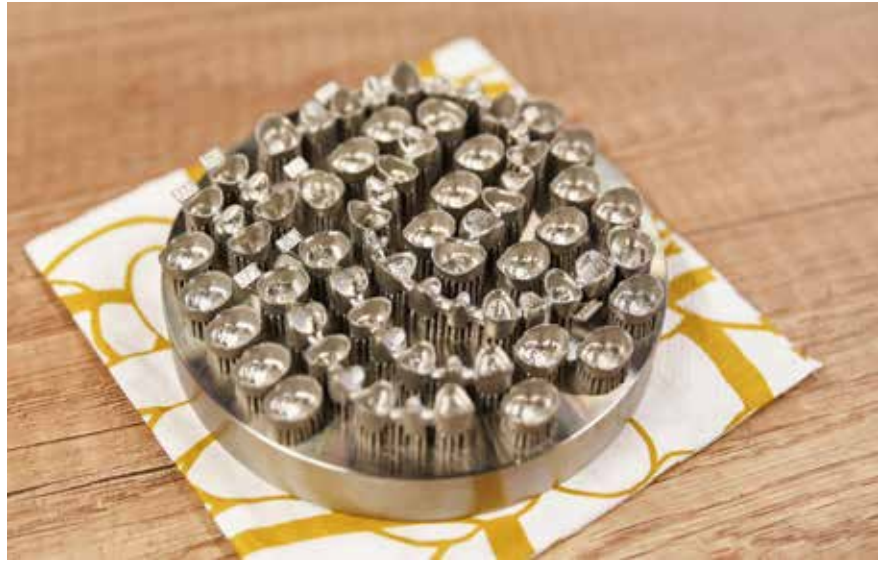
Kuva 7. Yksilöllisiä hammaskruunuja tulostusalustalla. Huomaa tulostustuet
