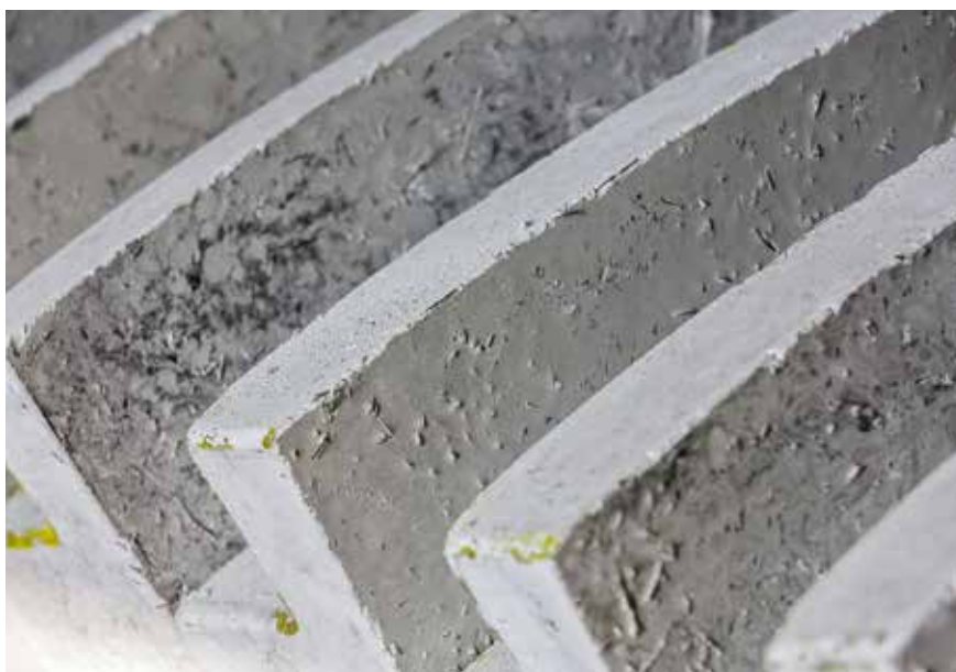
Terässenkan huulibloki, keraami-metallikomposiitti
