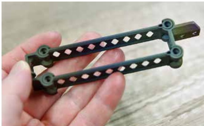
Kuva 3. Toimiva nivelnelikulmio liikkuvine nivelineen voidaan valmistaa yhdellä tulostuskerralla.
