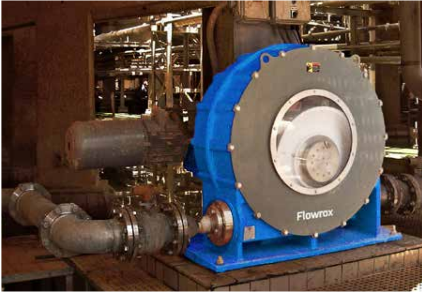
Rullaavalla paininyörällä varustetut letkupumput ovat paras ratkaisu sakeutetulle rikastehiekalle, jonka kiintoainepitoisuus saattaa olla jopa 80 %. Kuva: Valmet
