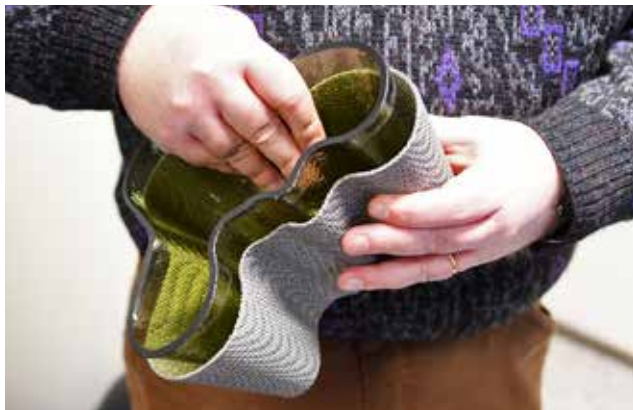
Kuva 2. Tulostettu lasimuotti ja siihen puhallettu maljakko
