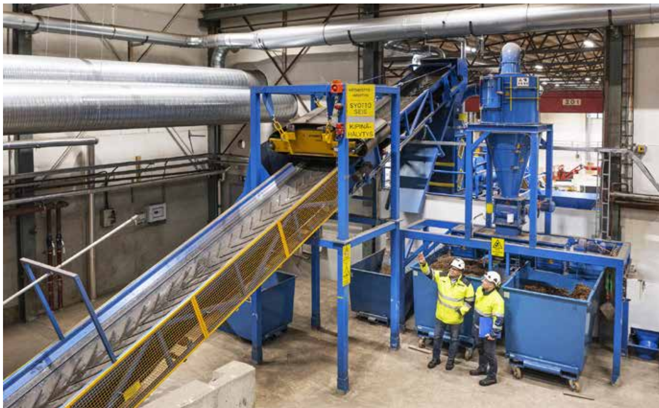
Kuparikeskuksen esimurskauslinjalla materiaali murskataan ja erotellaan magneettierottimien ja tuuliseulan avulla.
