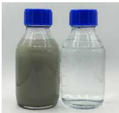
Kuva 1. Vasemmalla kairasydänten sahausprosessissa syntyvää vettä ja oikealla Sofi-suodattimella aktiivihiihlä apuaineena käyttäen tuotettua kirkasta suodosta.
