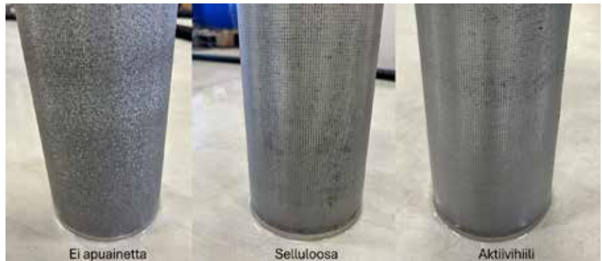
Kuva 3. Apuaineiden vaikutus elementin pinnan likaantumiseen.
