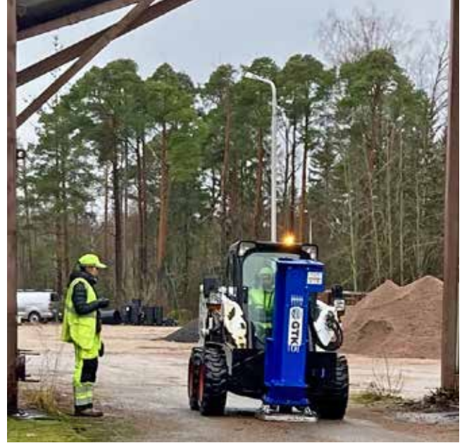
Viveka Laakso ja Markus Penttinen tekevät heijastusseismistä mittausta Kotkan Sunilassa. Seisminen signaali tuotetaan kuormaajaan kiinnitetyllä pudotuspainolla. Kuva: GTK.
