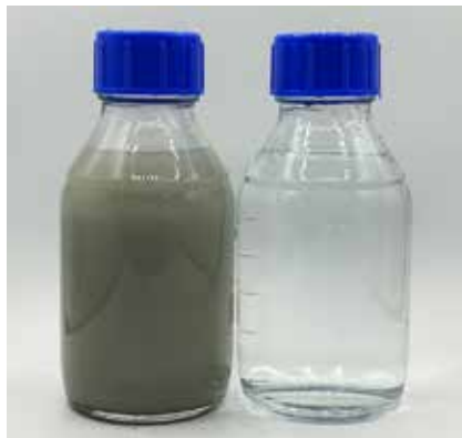
Kuva 1. Vasemmalla kairasydänten sahausprosessissa syntyvää vettä ja oikealla Sofi-suodattimella aktiivihiltä apuaineena käyttäen tuotettua kirkasta suodosta.
