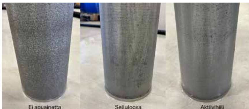
Kuva 3. Apuaineiden vaikutus elementin pinnan likaantumiseen.
