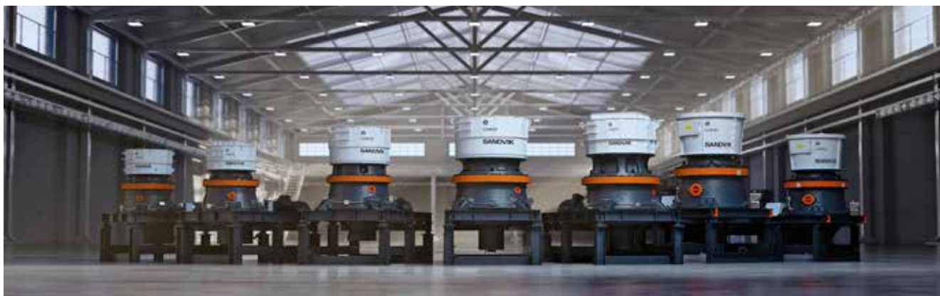
Svedalassa valmistetut 800i-sarjan kartiomurskaimet on varustettu ACS-c 5 -automaatiojärjestelmällä, joka varmistaa parhaan käyttöasteen, tuottavuuden ja luotettavuuden.
