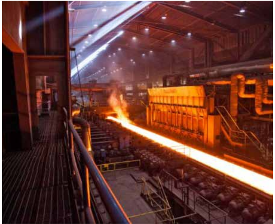
Avestan tuotantolaitos on yksi kolmesta Outokummun integroiduista Ruotsin tuotantolaitoksista, joissa sulatetaan, kuumavalssataan ja kylmävalssataan. Kuvassa Avestan kuumavalssaamo
